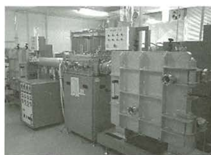
図5 大面積スパッタ蒸着装置 Fig 5. Large Area sputtering equipment
