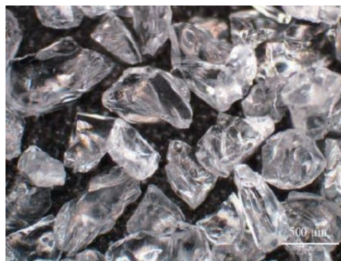
図3 PolyHEMA/TMPT 粒子 (光学顕微鏡像)
