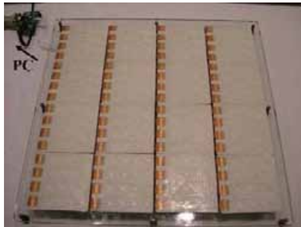
図4. ストレッチャブルセンサシートを自己組織化情報処理システムに接続することにより作製した大面積触覚センサシステム(256チャンネル)。
