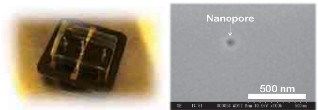
図 3 (a) サラウンドゲーティングナノポアデバイス. (b) 直径 20 nm のサラウンドゲーティングナノポアの SEM 像。
