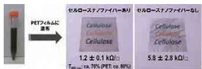
図 4 セルロースナノファイバーベースの導電性ナノインク
