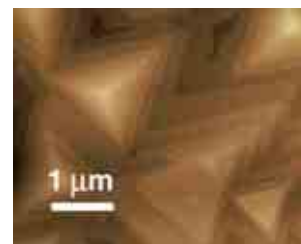
図2：我々が開発した方法で作製された \text{Bi}_2\text{Se}_3 薄膜表面の原子間力顕微鏡による観察像。原子レベルで平坦なテラスが 1\ \mu\text{m} オーダーの広さで得られている。
