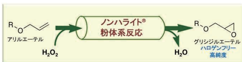
図 3 ノンハライト®によるエポキシ化反応
