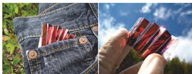
図 2 軽くて持ち運びやすいナノペーパー太陽電池
