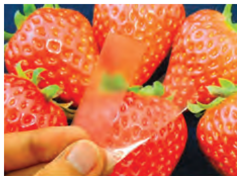
図 6 高濃度懸濁液からの半透明ナノペーパー(左)及び希釈超音波法による高透明ナノペーパー(右)
