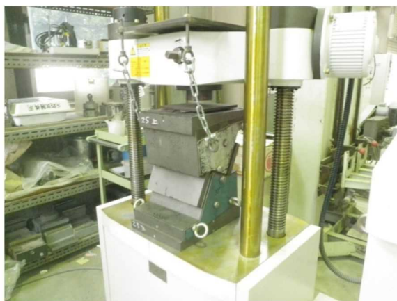
図-7.2.7 簡易一面せん断試験装置の模式図と試験状況
