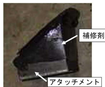
補修剤で角度調整 を行ったアタッチメント
