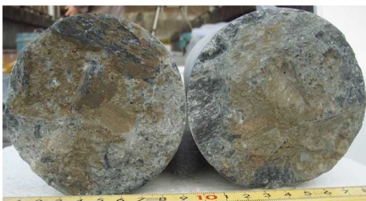
図-3.4.6 ボーリング調査で採取されたコアの不連続面(14.69m)の断面
