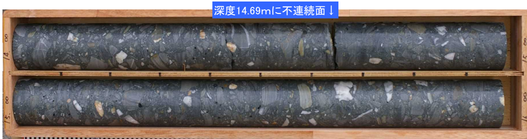
図-3.4.5 天端からのボーリング調査で採取されたボーリングコアの例
