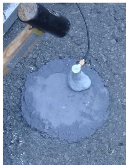
金属補修剤で補強した面での計測
