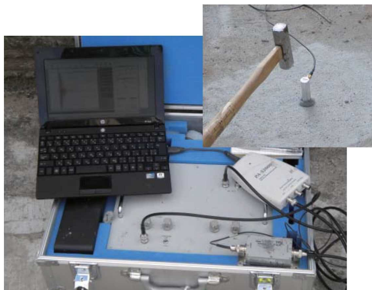
図-4. 2. 1 調査装置の構成 (装置本体, 受信センサ, 鋼製ハンマー)
