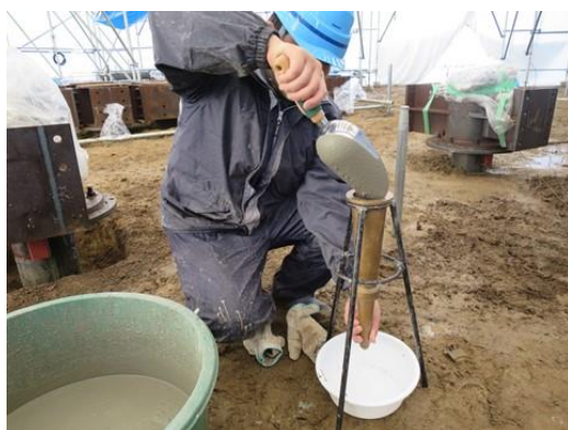
(c) 無収縮モルタルの流下試験
