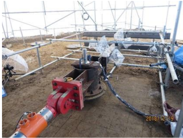
写真 3.5 単杭実験（杭頭固定）
