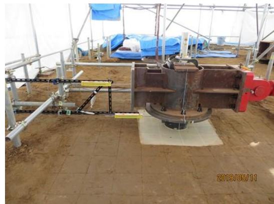
写真 4.5 水平変位計と杭頭傾斜計の設置
