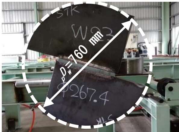
写真 4.3 先端の羽根形状
