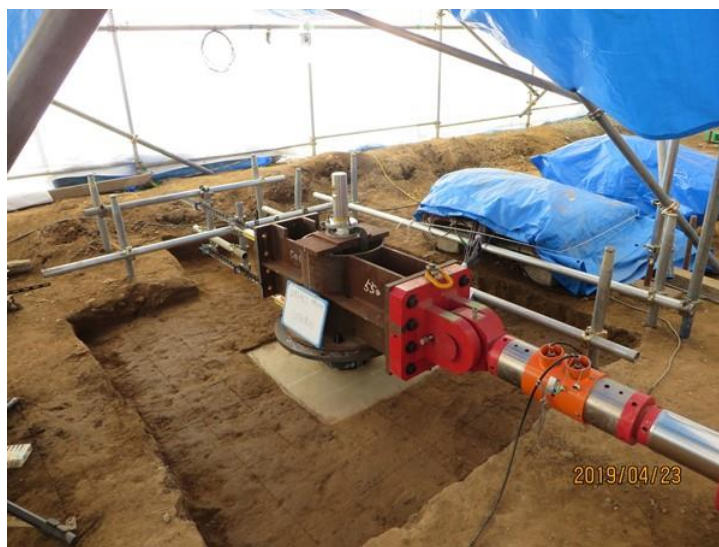
写真 4.2 载荷実験状況
