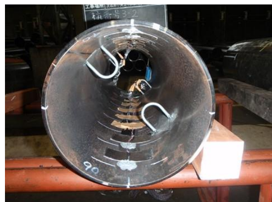
写真 4.7 杭内面のひずみゲージ貼付状況
