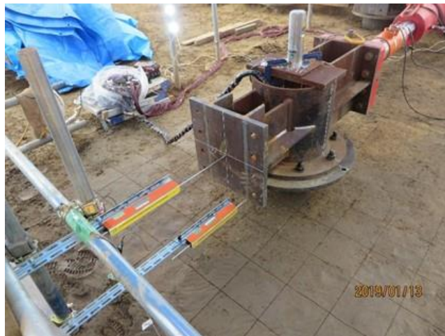
写真 3.6 単杭実験（杭頭自由）
