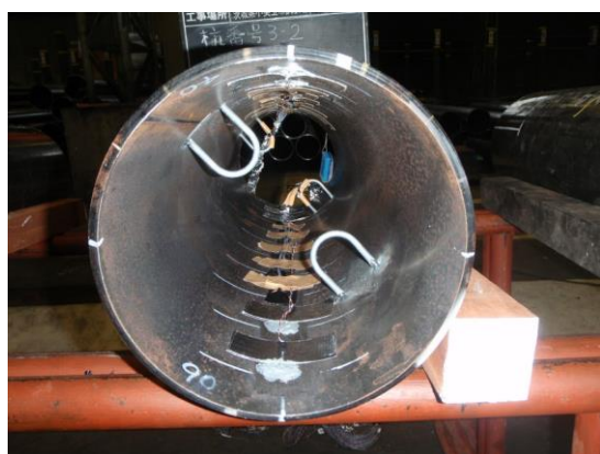
(a) ひずみゲージ貼付状況
