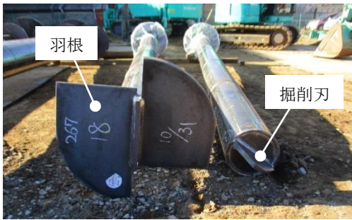
写真 3.2 実験杭の先端形状
