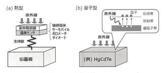
図3 熱型、量子型赤外線センサイメージ
