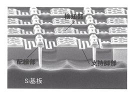
図 6 画素構造の鳥瞰電子顕微鏡画像 Fig 6. The picture of pixels with using scanning electron microscope
