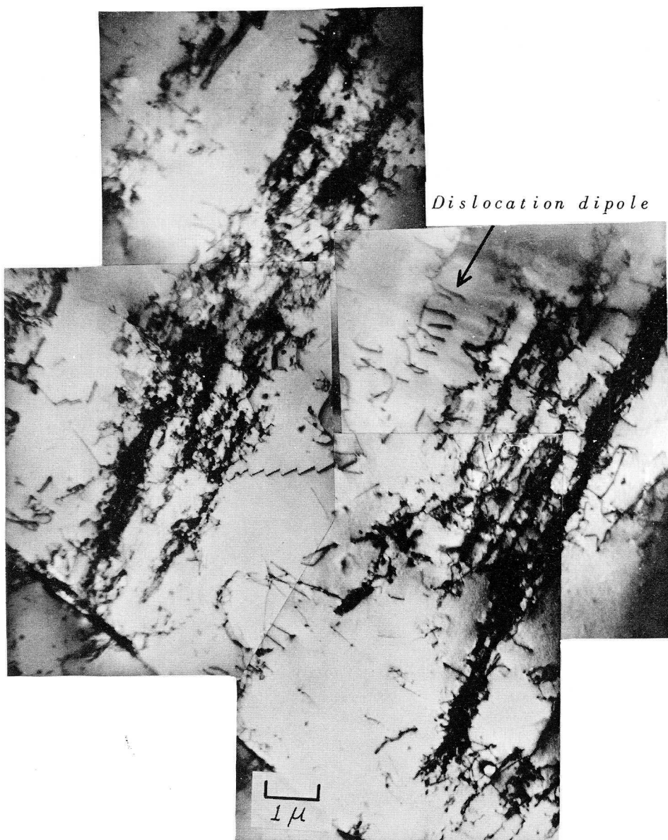
図 3-2-18 低応力疲労過程中に形成された, 発達した
