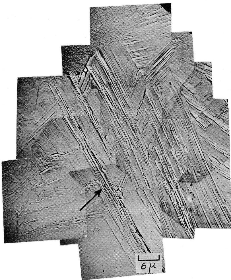
図 2-4-8 結晶粒界近傍に生じた交差すべり
