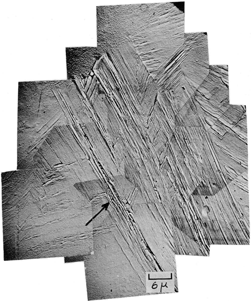
図 2-4-8 結晶粒界近傍に生じた交差すべり
