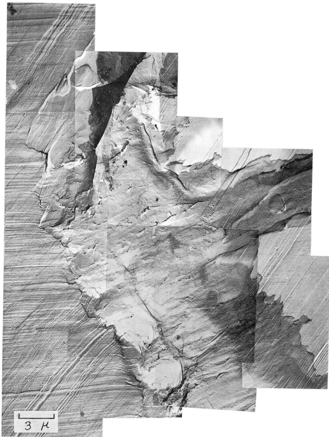
図 2-3-12 疲労き裂およびその近傍の変形組織
