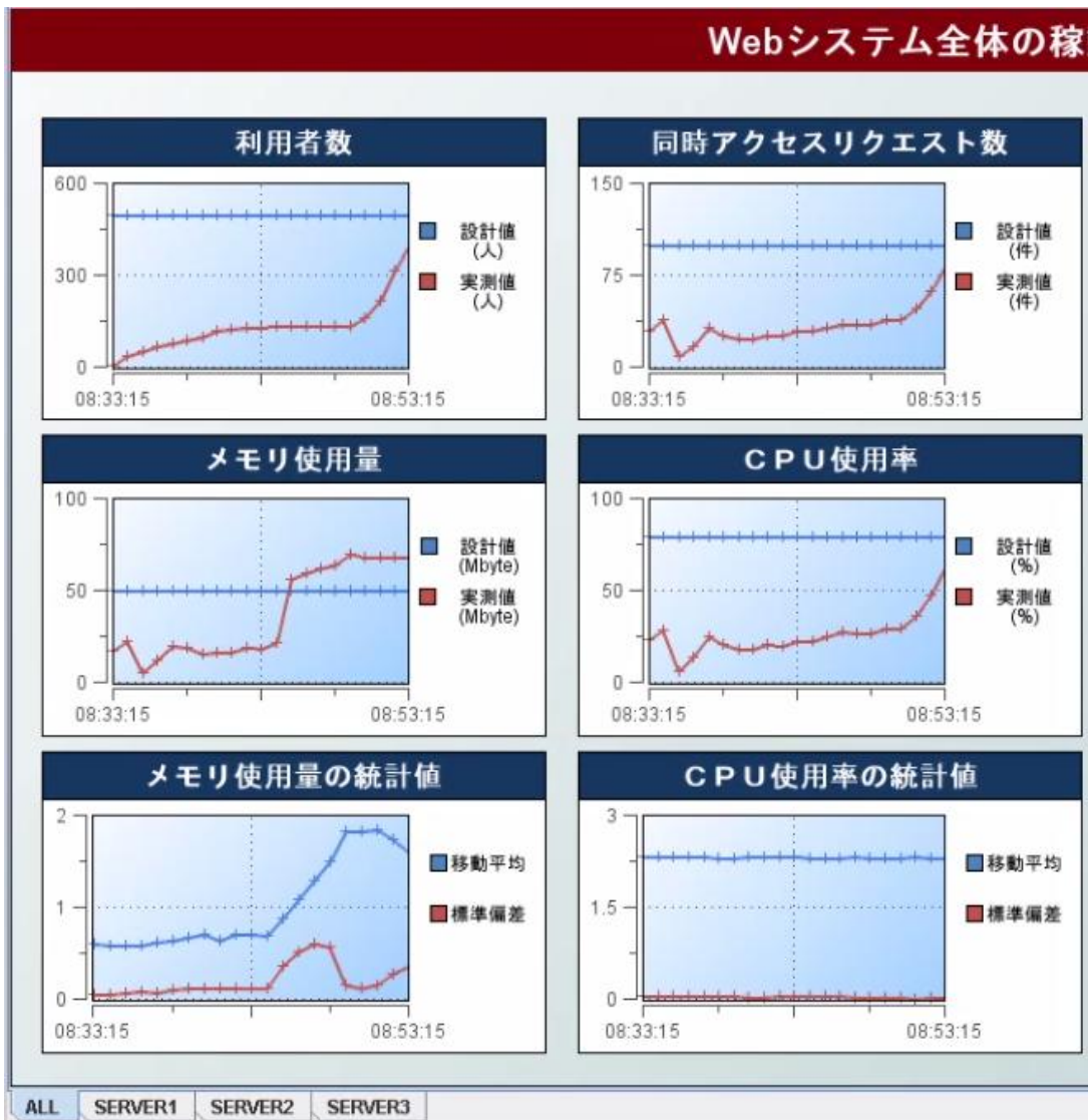
図 4-5 設計基準値と実測基準値の乖離による障害予兆検知例
