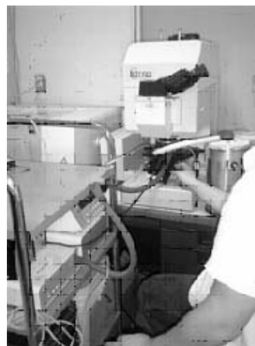
図 2 顕微赤外分光計に低温ステージと冷却システムを設置した様子。
