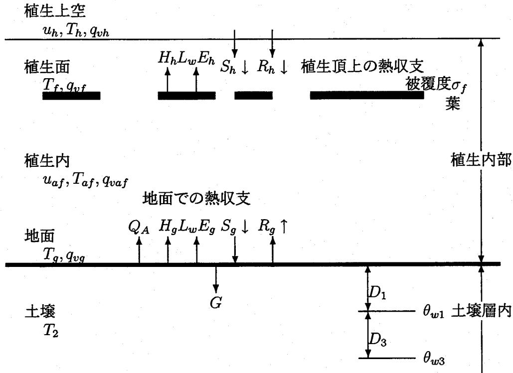
図 2.3 热収支モデルの概念図
