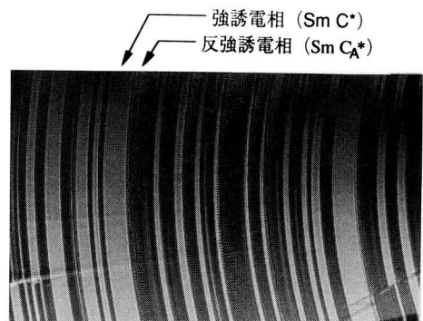
図4 ホモニアス配向セルの反強誘電相における電界誘起相転移時の偏光顕微鏡写真
