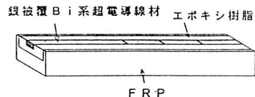
(b) FRPに補強された状態
