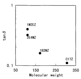
図10 tan δと触媒分子量との関係 Fig. 10 Relationship between tan δ and molecular weight of imidazoles. れているためではないかと推測される。
