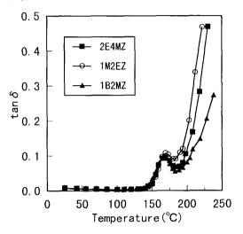
図9 触媒構造の違いによるtan & の温度依存性 Fig. 9 Temperature dependence of tan & with different imidazoles.
