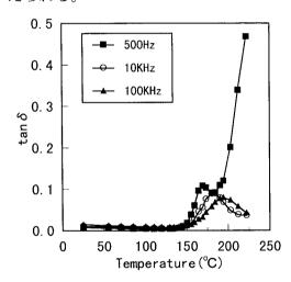
図2 1M2EZを使用した樹脂のtan & の温度依存性 Fig. 2 Temperature dependence of tan & of epoxy resins added with 1M2EZ.
