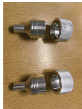
Fig. 2. オリジナル（上）と工作室で作ってもらった液面計のヘッド（下）
