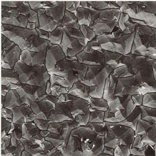
図5. (100) 厚膜試料のSEM像
