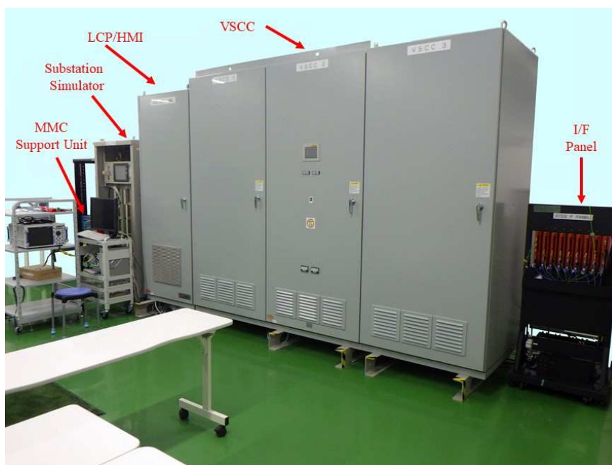
図 2 - 16 リアルタイムシミュレータのハウスマシン
