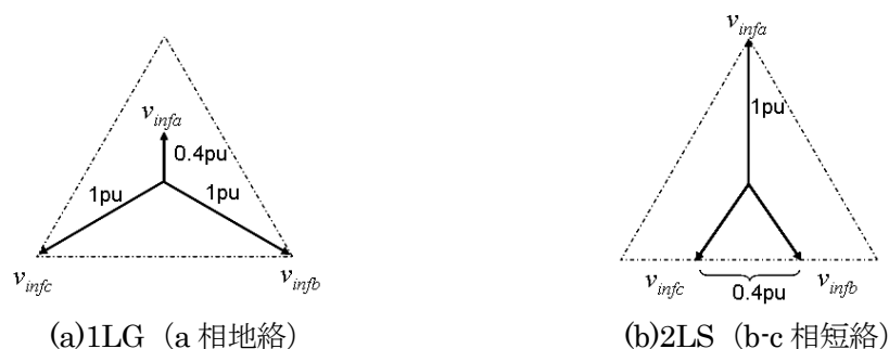
図 5.18 事故時の系統電圧
