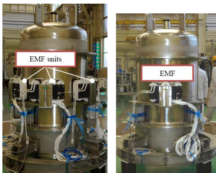
図 3.4.2-3 環状流路用 EMF 設置画像
