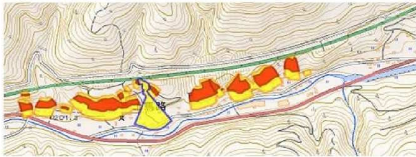
黄色区域：土石流災害監視区域 赤色区域：土石流災害特別監視区域 図 6.5.11 探査実施区間のハザードマップ(土石流危険溪流)
