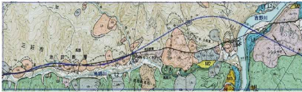
【凡例】Ls: 地すべり地, M, L: 河岸段丘, Iz: 和泉層群, Ms: 三波川変成岩類, ー: 中央構造線 (a) 徳島自動車道における地形地質図
