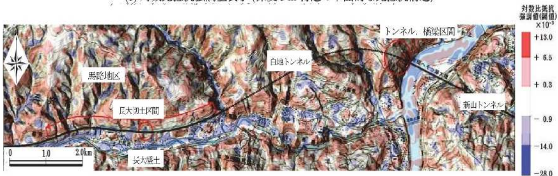
(d) 対数比抵抗強調値 (閾値) 表示 (深度 5m 付近の平面的な比抵抗構造)
