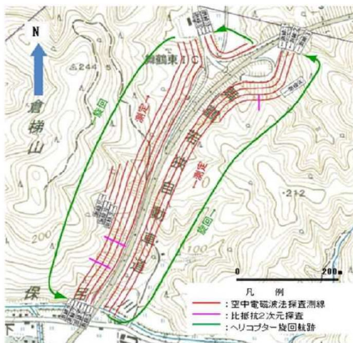
図 5.2.6 空中電磁法探査の測線設定と飛行航路
