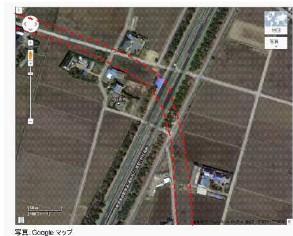
写真 2.4.8 旧河川上での液状化の発生状況(赤線が旧河川部) 8)
