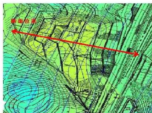
(b) 空中電磁法探査の比抵抗分布
