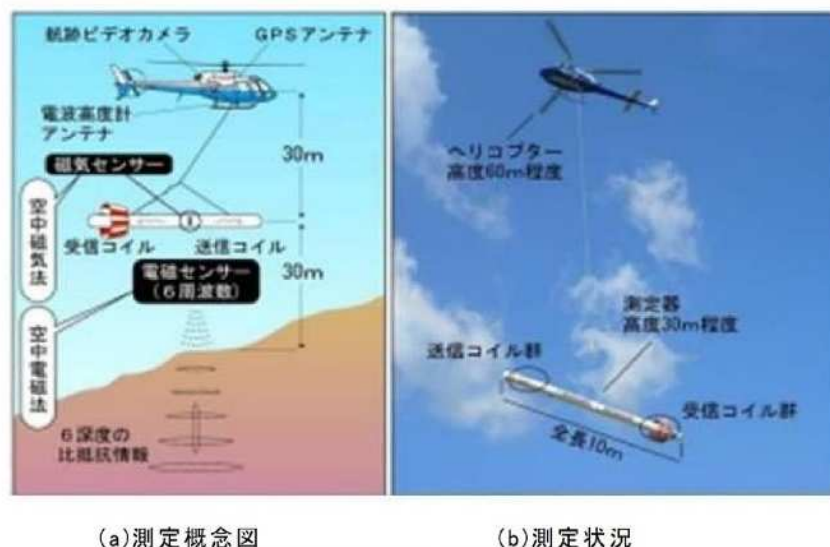
図 4.2.1 空中電磁法探査の概要図 15),16)
