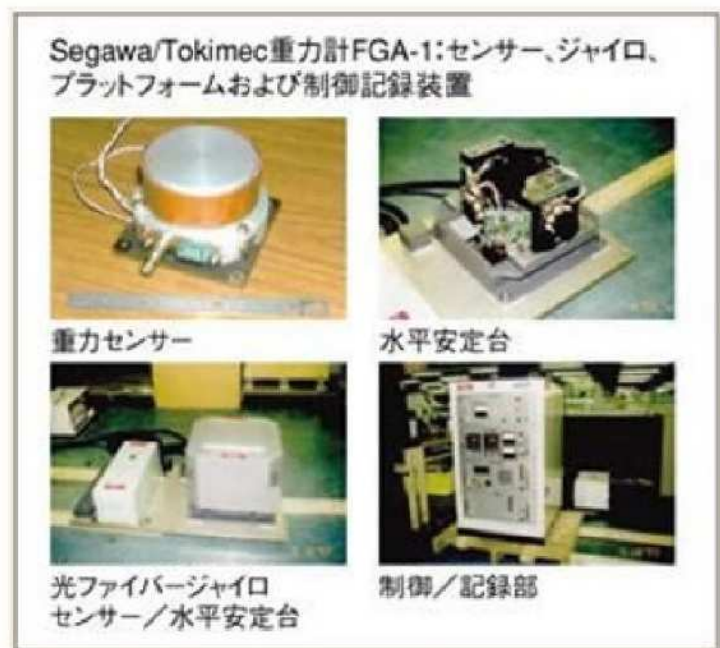
図 3.3.4 空中重力探査の測定機器類
