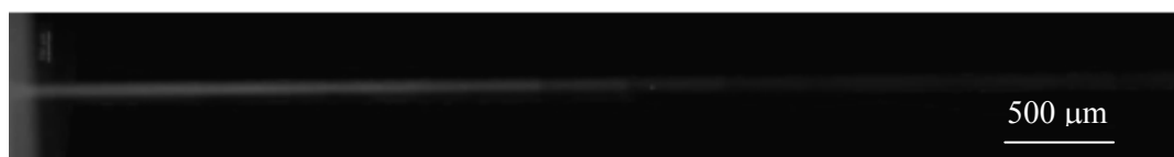
図 2.3.6 RPL ガラス中の X 線マイクロビームの軌跡を蛍光観察した様子(X 線マイクロビームは左面から入射)
