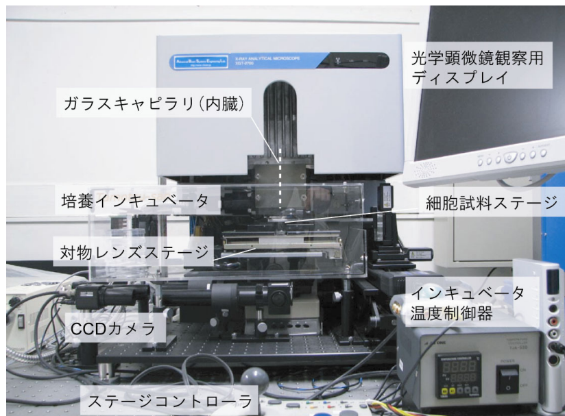
図 2.2.2 卓上型 X 線マイクロビーム照射装置の写真
