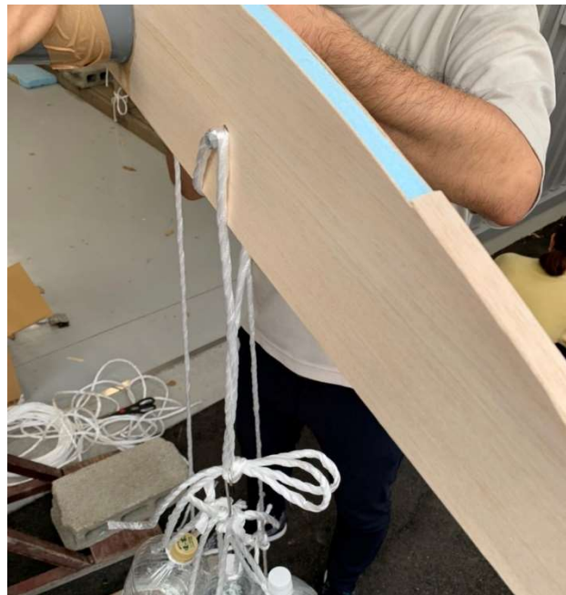
図 5 ねじれ試験の様子
