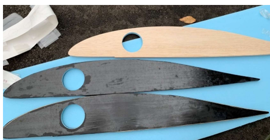
図 1 上:バルサリブ 中:カーボンだけのリブ 下:バルサ+カーボンリブ
