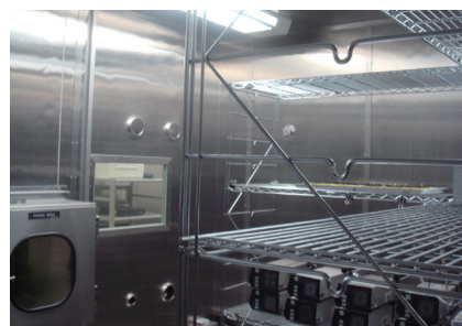
写真5 放射性のラドンガスの場を作るラドンチェンバー
