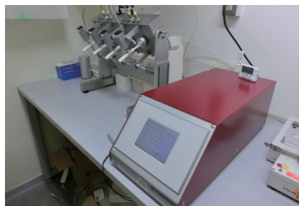
写真4 加熱式たばこ主流煙捕集用の喫煙装置
