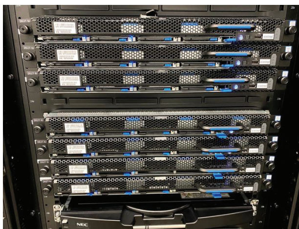
図 22: ラックに搭載された ONION 構成オブジェクトストレージ
