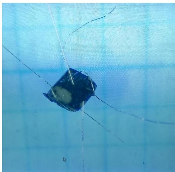
**Fig.4.4** ホール効果のために端子（金線）を接続された d[3,3]体。
