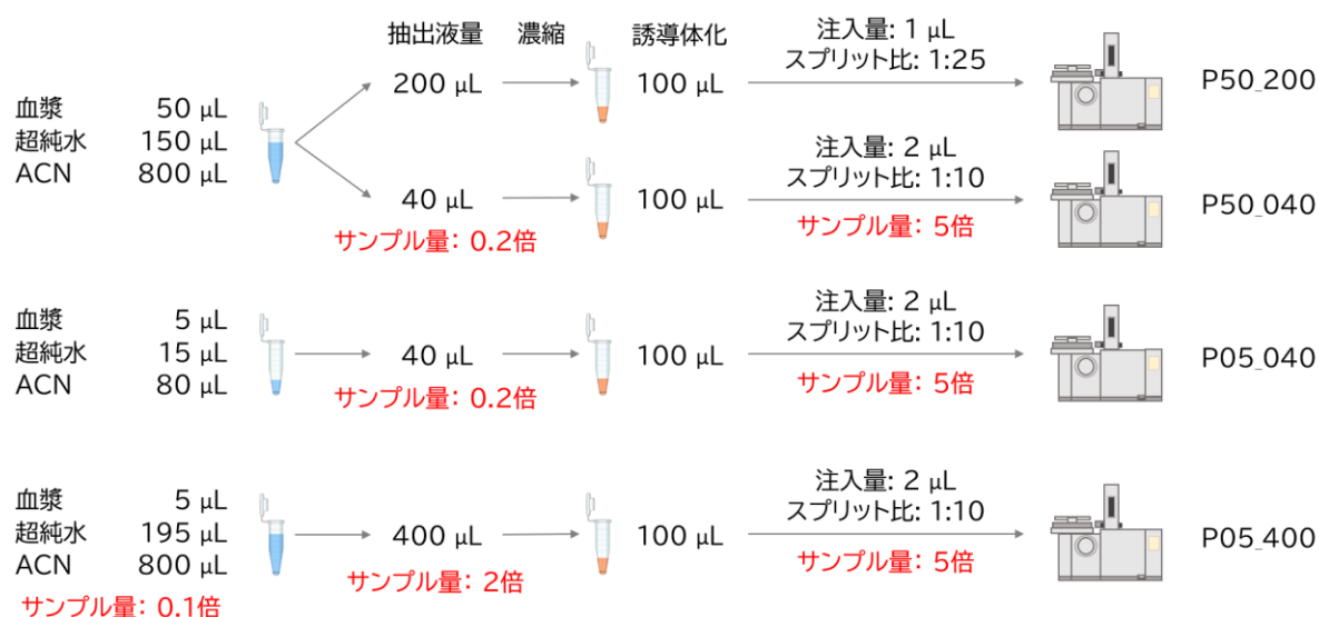
図 4: 抽出液の濃縮および GC カラムへの注入量増加における実際の分析手順とサンプル負荷量の変動
