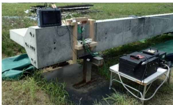
図 5.6.6 PC 桁供試体測定状況（全景）
