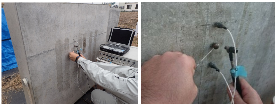
図 4.3.15 板状コンクリート供試体測定状況
