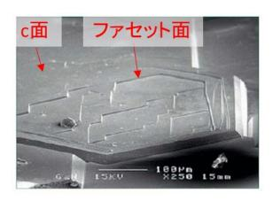
図 3-20 Na フラックス成長時の c 面及びファセット面  $^{19}$ 。参考文献[19]を一部改変して掲載。
