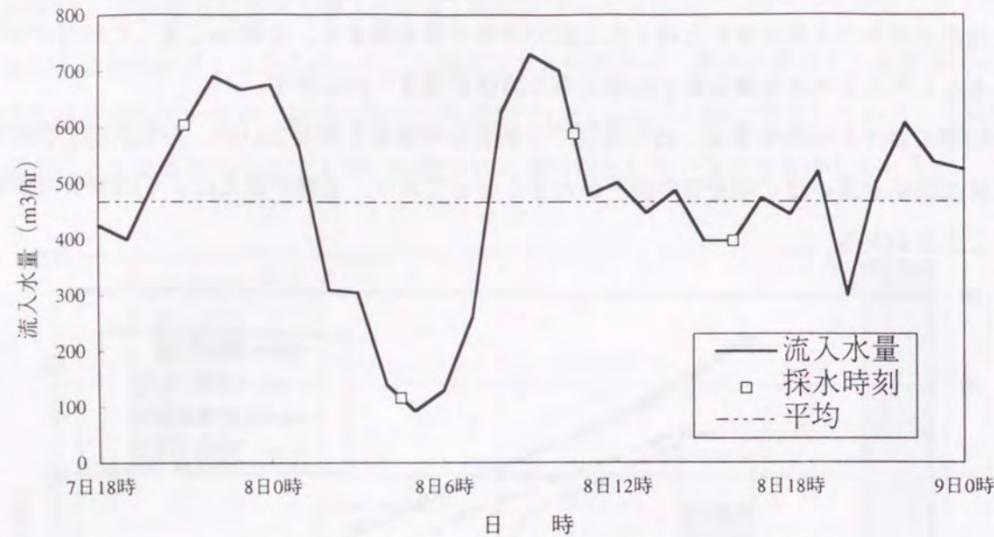
図3-14 流入水量の経時変動と採水時刻の関係
