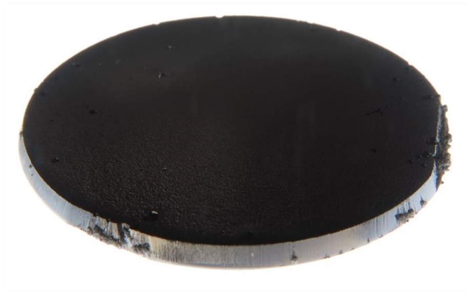
図 5.21 OVPE 製 1.3 ~ 1.4 mm 厚の口径 2 インチバルク GaN 結晶.
