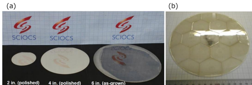
図 2.1 (a)VAS 法によって作製された 2~6 inch サイズの HVPE 製 GaN 基板[6], copyright 2017 by the Japan Society of Applied Physics. (b)Tiling 法によって作製された 7 inch サイズの HVPE 製 GaN 基板[7], copyright 2017 by WILEY.
