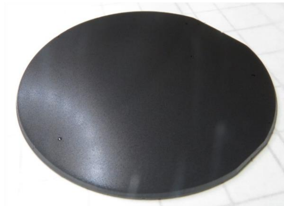
図 5.18 206 \mu\text{m}/\text{h} で成長した 672 \mu\text{m} 厚の 3D-OVPE-GaN 結晶。
