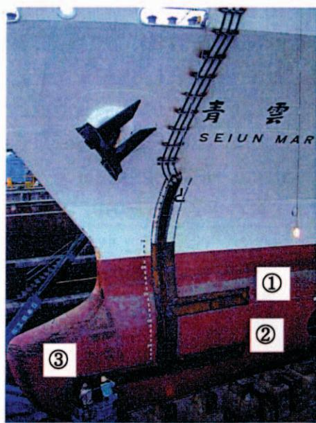
図6.4.1 青雲丸の気泡発生装置
