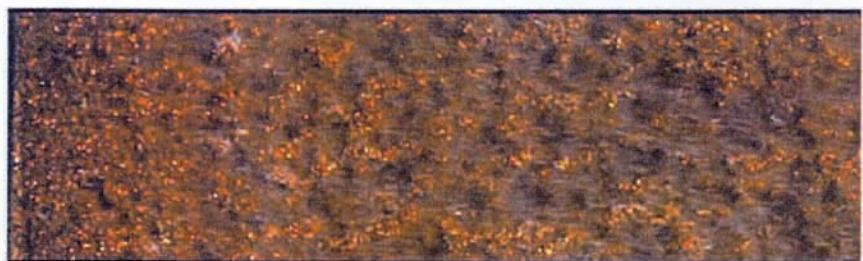
図 4.1.2.4 多孔質板からの気泡発生を下から撮影(流れは左から右)
