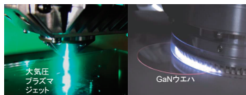
プラズマCVM: 非接触な化学的エッチングによりナノ精度の形状をダメージフリーに創成 プラズマ援用研磨: プラズマ改質と軟質固定砥粒研磨により高効率ダメージフリー研磨を実現
