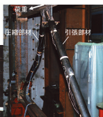
鋼管筋違の曲げ座屈
