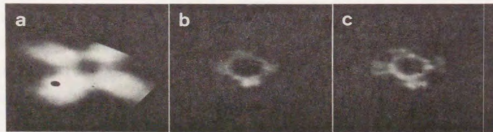
図 2-16 電界放射によるエミッションパターンの変化 (a) フラッシュ直後, (b) 1 分後, (c) 5 分後
