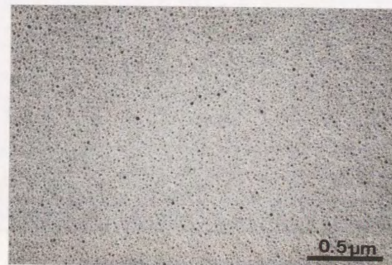
図 2-25 カーボン薄膜と金の微粒子の電子顕微鏡像
