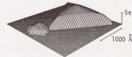
図 1-18 縞走査再生法により得られた位相分布 (Yatagai et al., 1987)
