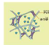
図3 網目構造の様子 化学だいすきクラブ ① より改
