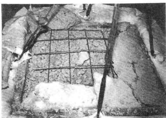
写真1.2 爆裂後の試験体
