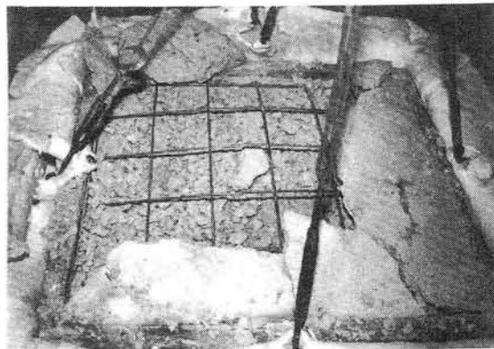
写真1.2 爆裂後の試験体
