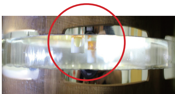
図3. 液体ヘリウムに浸かっているサンプル棒（2本）の先端の様子
