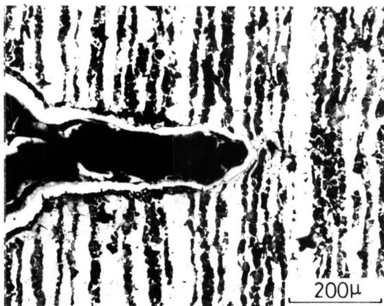
図6-8 引き裂き形き裂伝ば
