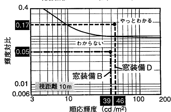
図 8.7 細部の見え易さの予測資料 (視距離 10 m ・ 確率 80%)
