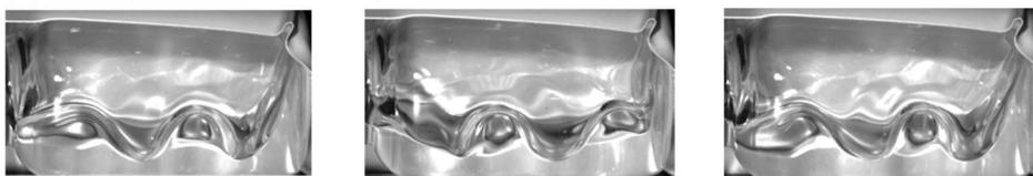
図 24 0.5 mg/mL IgG in HB NaCl 1 mL を含むバイアルを, AAB (2.0 G) (a) 及び ABB (0.7 G) (b) で 10 Hz で振とうしたハイスピードカメラ画像, 同じバイアルを AAB (6.3 G) (c) 及び ABB (3.5 G) (d) で 50 Hz で振とうしたハイスピードカメラ画像. 振とう開始から約 5 秒後に撮影した. 波の乱れを黄色で囲んだ.
