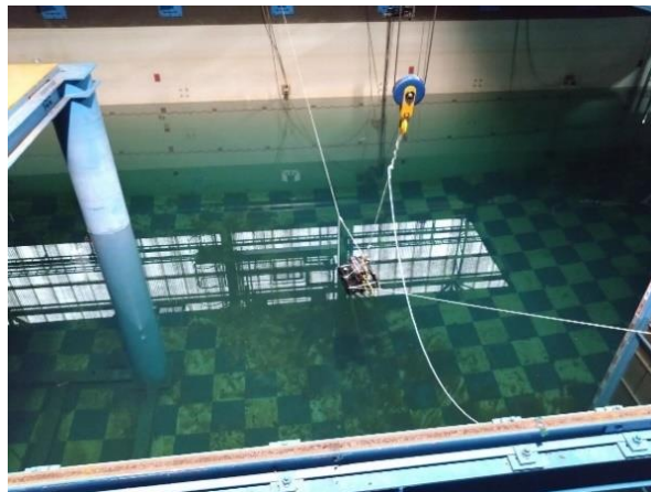
図 6.1 静置・スラスト静止状態での方位計測実験
