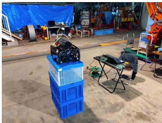
図 6.4 起動直後のセンサの計測試験の実施状況
