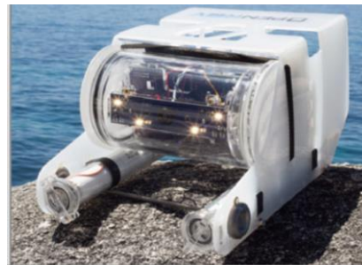
(2) Open ROV（米国 Open ROV 社製） 写真の出典: 参考文献 2)
