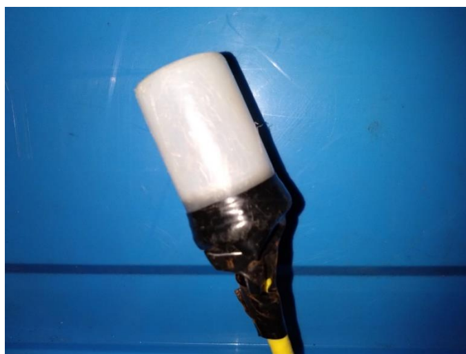
図 5.6 フィルムケースに入れた無線 LAN アンテナの状況
