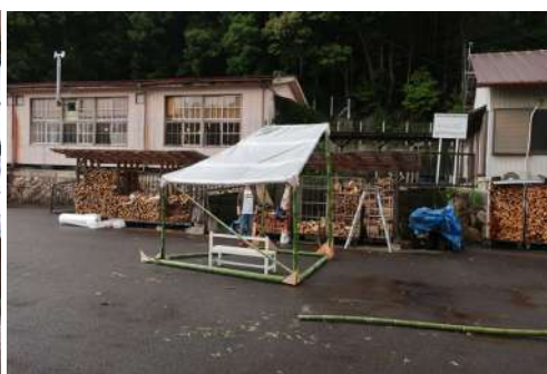
写真 3-9 竹による試作で耐風耐雨性能の確認
