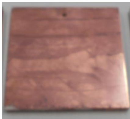
Figure 3-15 無電解 Cu めっきをした Pd/ABS 10 vol%の外観写真(アクセラレータ処理なし)
