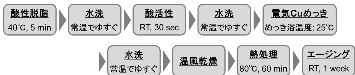
Figure 3-6 電解 Cu めっきの手順
