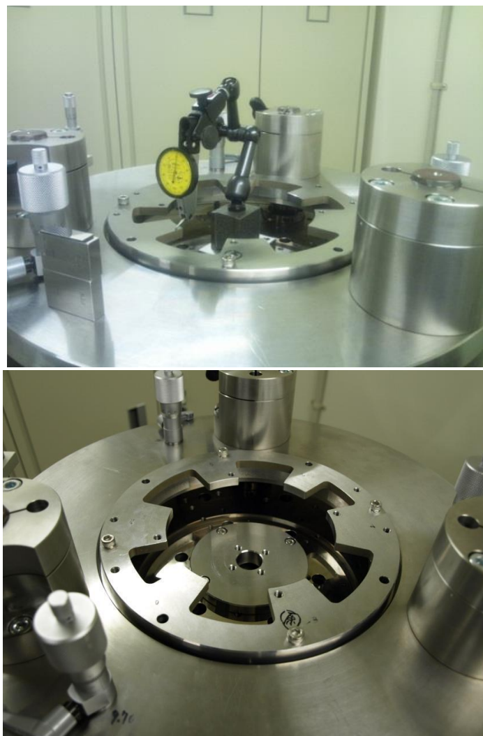
図 4.5 ブラケットの調整の様子（上）とスケールブラケット設置後の様子（下）
