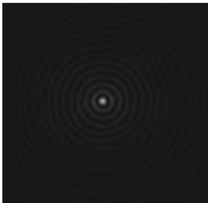
図 5.7. アキシコンレンズの焦点面の光強度分布
